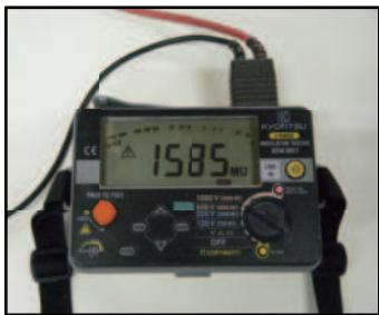
電源ケーブルの黒または白を絶縁抵抗計（500V）のラインプローブへ、アース線を絶縁抵抗計のアースプローブに接続して測定します。
